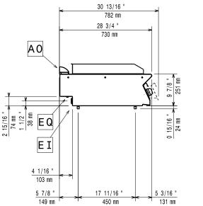
El = Electrical inlet (power) Equipotential screw
